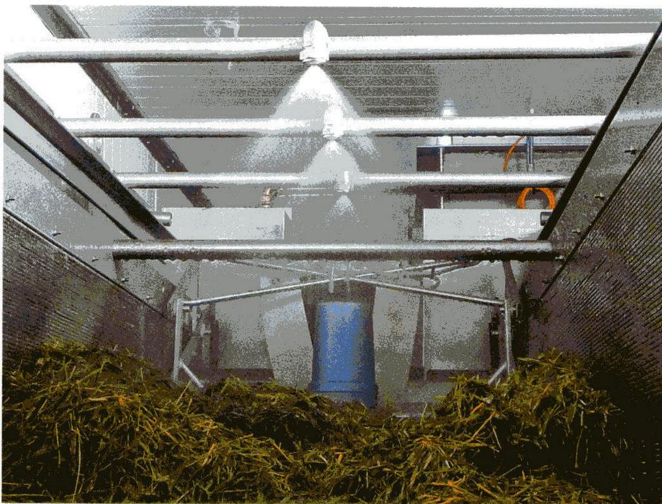
**Blick in den Anmisch-Behälter: Hier wird die Biomasse 30 Minuten lang mit 30 °C warmem Wasser beregnet.**
